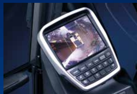
SAVM: bezpieczne pole widzenia we wszystkich kierunkach dzięki dostępności dziesięciu widoków, w tym widoku z lotu ptaka 3D oraz widoku 2D/4CH.
